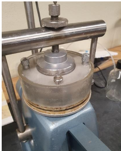
Figura 3.7 - Ensaio edométrico do provete.
