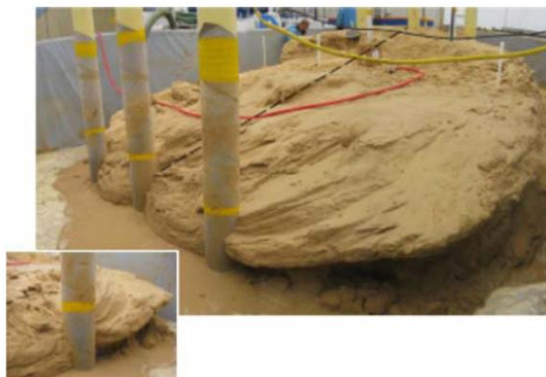
Figura 2.12 - Imagem de um tratamento de bio-cimentação a larga escala. Adaptado de van Paassen et al. (2010).
