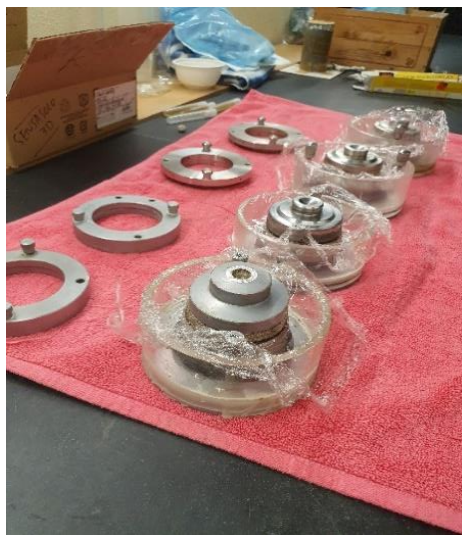
Figura 3.5 – Disposição dos 4 provetes tratados com bactérias
