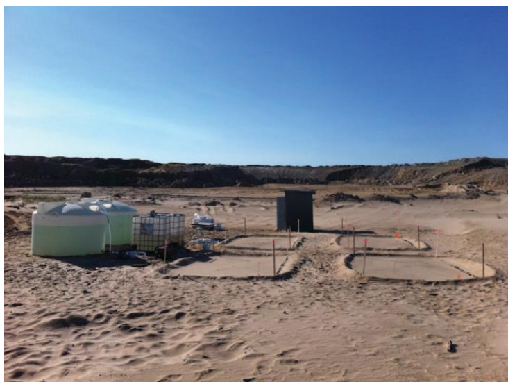
Figura 2.9 - Zonas de teste submetidas ao tratamento MICP. Adaptado de Gomez et al. (2015).
